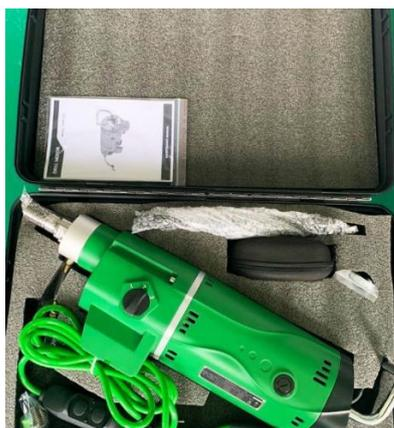
Установка алмазного бурения BYCON PRO-350L (DMP-352 + DSP-352) предназначена для сверления отверстий больших глубин в бетоне и кирпиче и других материалах.
